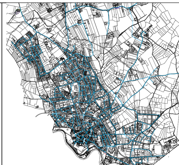
Comune di Pianezza - Schema della rete dell'acquedotto
